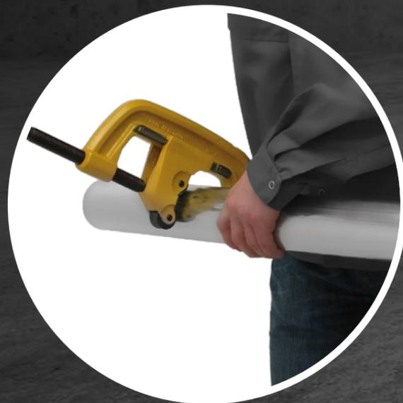
**01** Отрезание трубы с помощью специального роликового трубореза перпендикулярно к оси трубы (разрез должен быть полным, без отламывания надрезанных участков трубы).
