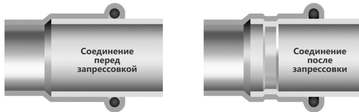
Соединение элементов в технологии „Press“ позволяет получить соединения с минимальным сужением сечения трубы, что существенно снижает потери давления во всей системе и положительно влияет на гидравлические характеристики.
