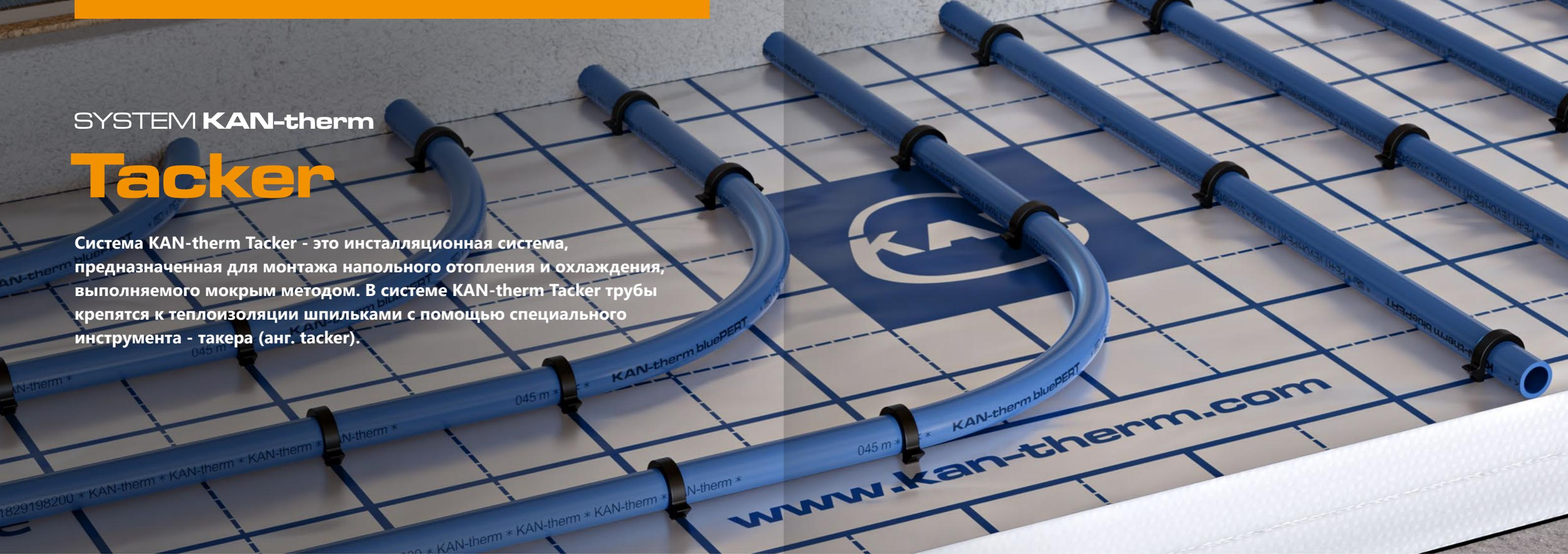
Конструкция отопительного прибора напольного отопления, смонтированного из элементов системы KAN-therm Tacker, относится к панельно-лучистому отоплению, выполненному мокрым методом. Греющие трубы крепятся к теплоизоляции пластмассовыми шпильками, которые вбиваются в пенополистирол с помощью специального инструмента - такера.
