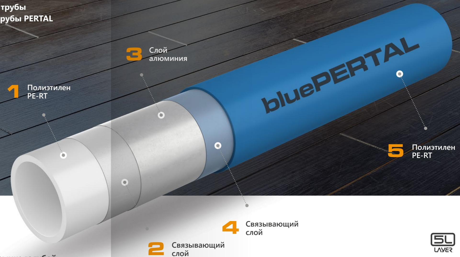
KAN-therm bluePERTAL - это продолжение популярной на рынке голубой линейки труб для напольных, настенных или потолочных систем отопления и охлаждения. KAN-therm bluePERTAL оценят любители труб со слоем алюминия. Высокая эластичность слоя алюминия обеспечивает легкую укладку и профилирование греющих и охлаждающих труб, а также устраняет эффект памяти формы в трубах bluePERTAL.
