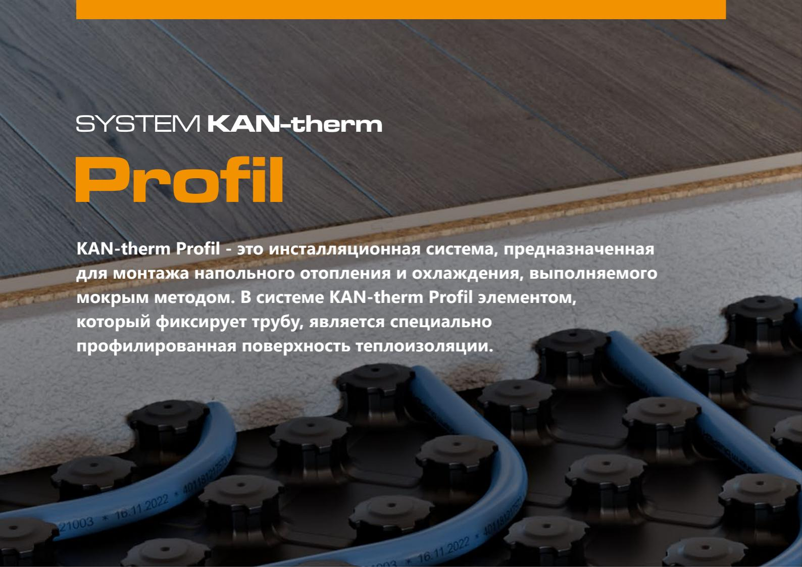
Конструкция напольного отопительного прибора из элементов системы KAN-therm Profil относится к панельно-лучистому отоплению, которое выполняется мокрым методом. Элементом, фиксирующим греющие трубы, являются специально профилированные выступы на поверхности теплоизоляции - пенополистирольных плит из жесткой пленки PS.
