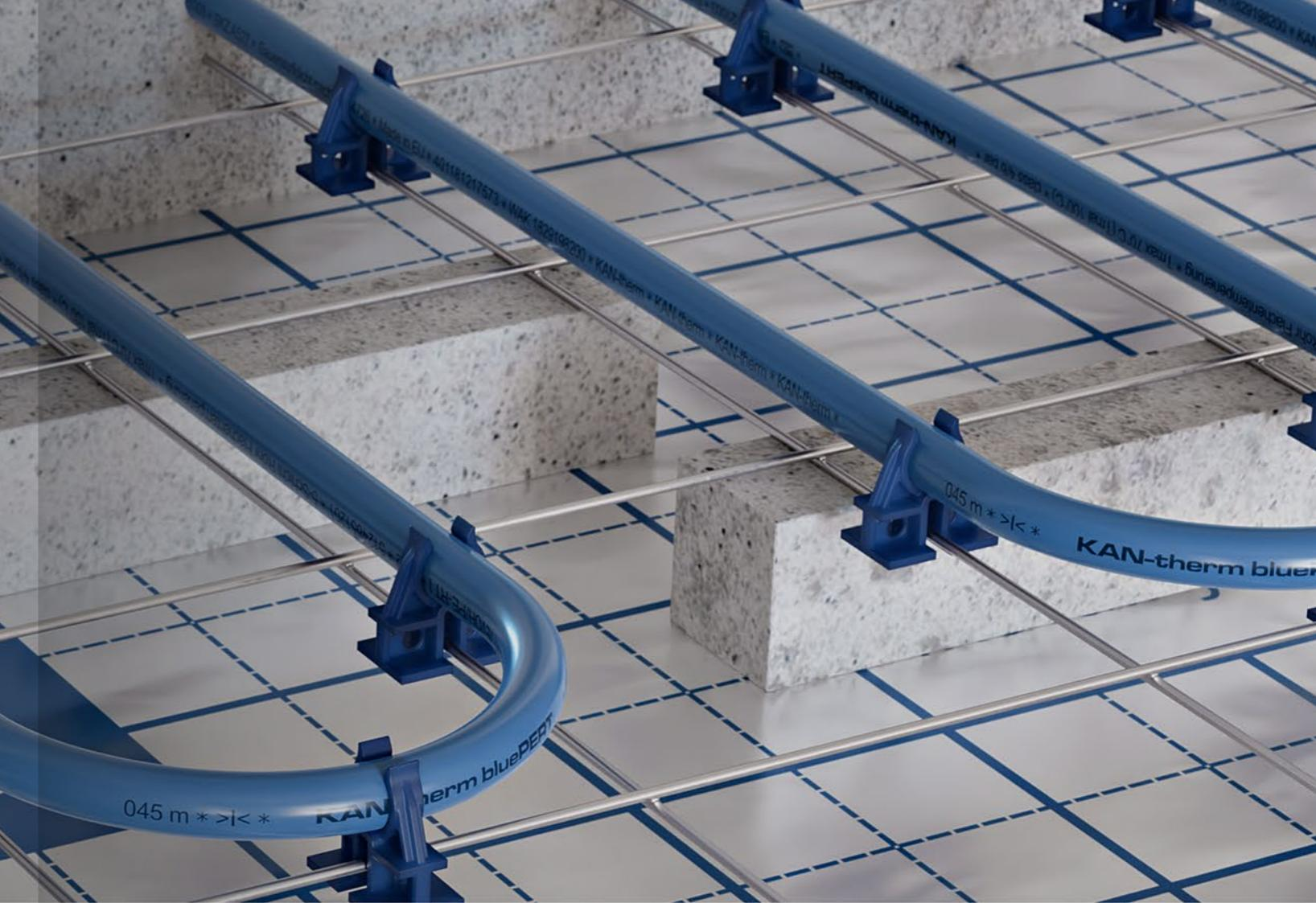
KAN-therm NET - это система крепления труб к основаниям разного вида: к теплоизоляции на бетонном основании, непосредственно к бетонному основанию или к грунту. Конструкция отопительного прибора панельно-лучистого отопления (или охлаждения) может варьироваться в зависимости от используемой теплоизоляции (или ее отсутствия), а также от вида и толщины слоев над трубами.
