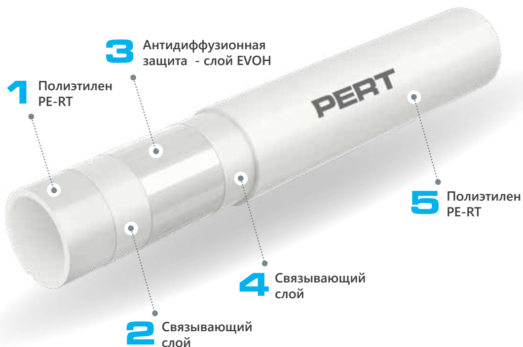
Конструкция трубы PERT со слоем EVOH
