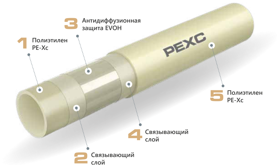
Конструкция трубы PEХС с антидиффузионным слоем
