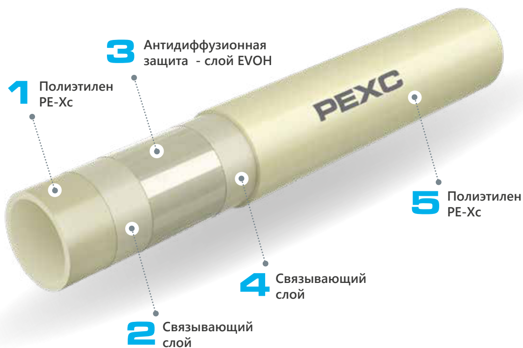
Конструкция трубы PE-XC со слоем EVOH
