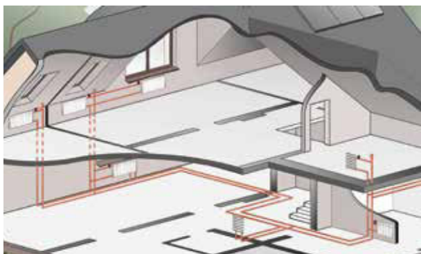
Вертикальная разводка со стояками в системе отопления
