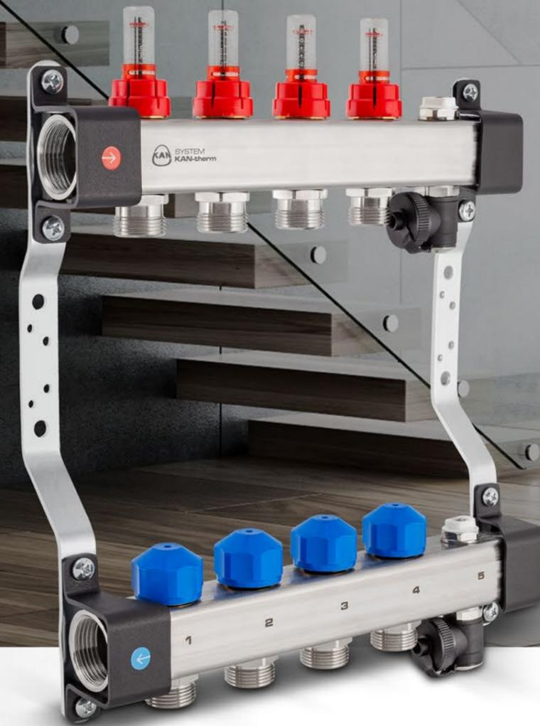
Инновационная технология производства, а также использование балки из нержавеющей стали с большим внутренним размером и меньшей толщиной стенки, чем в случае конструкции из латуни, привели к тому, что гидравлические возможности коллекторных групп KAN-therm InoxFlow повысились почти в два раза по сравнению с латунными версиями, без снижения механической прочности.
