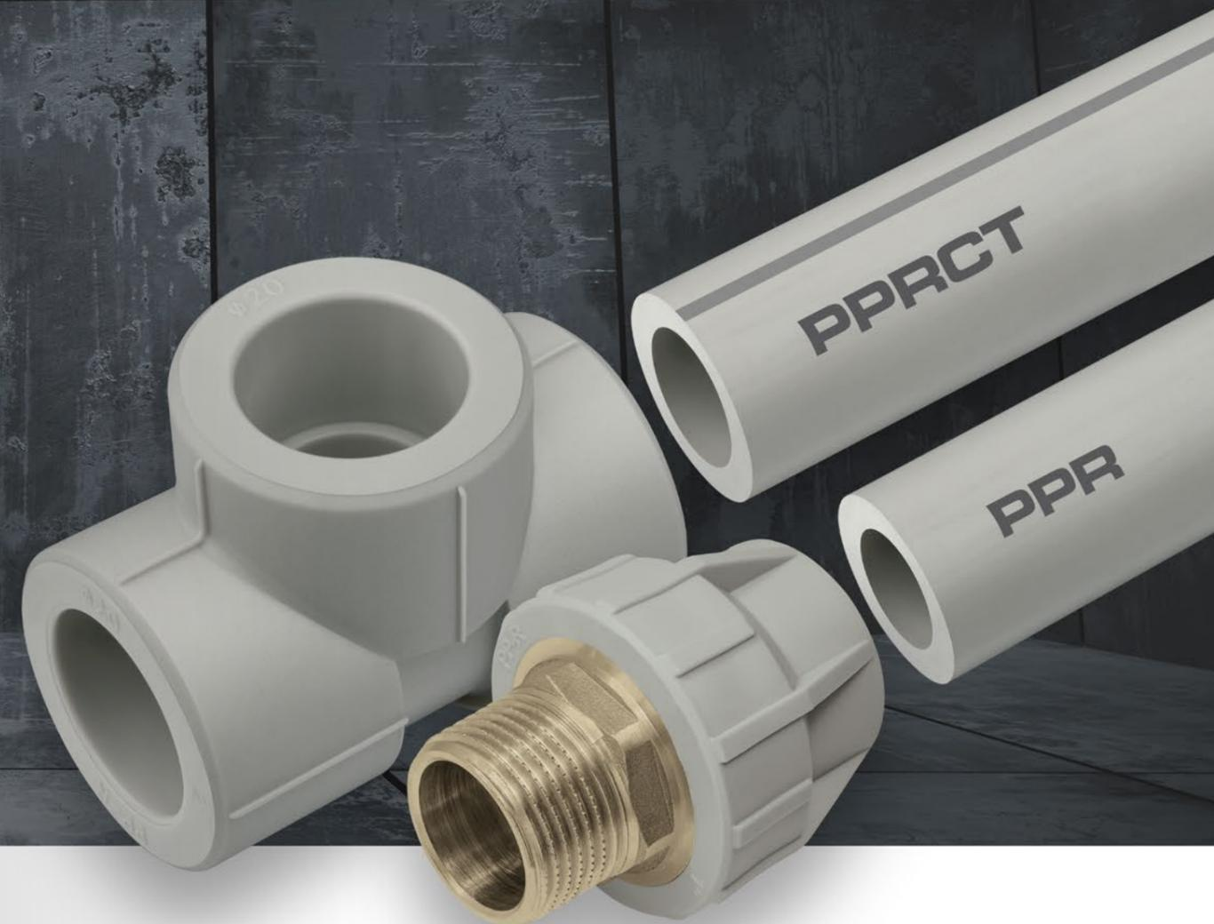
**Соединение элементов системы осуществляется методом муфтовой сварки (полифузионная термическая сварка) при помощи электрических сварочных аппаратов. Технология сварки, за счет однородности соединения, гарантирует исключительную герметичность и механическую прочность системы.**
