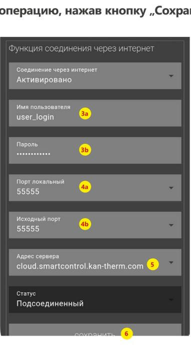
Если ваша клеммная колодка не видна в приложении (например, она не работает в локальной сети), введите те же данные непосредственно в меню конфигурации клеммной колодки.
