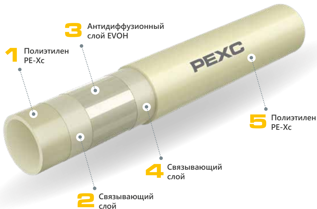
Конструкция трубы PEXC со слоем EVOH
