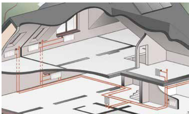
Вертикальная разводка со стояками в системе отопления
