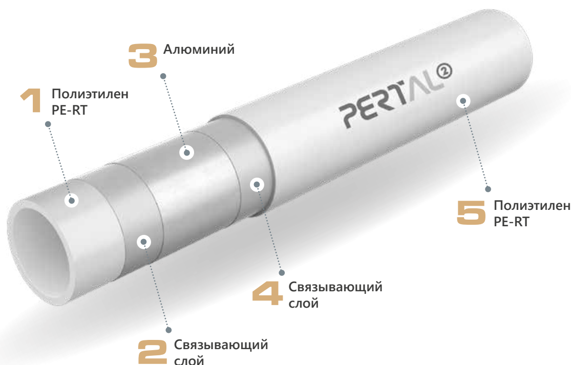
Конструкция трубы PERTAL 2
