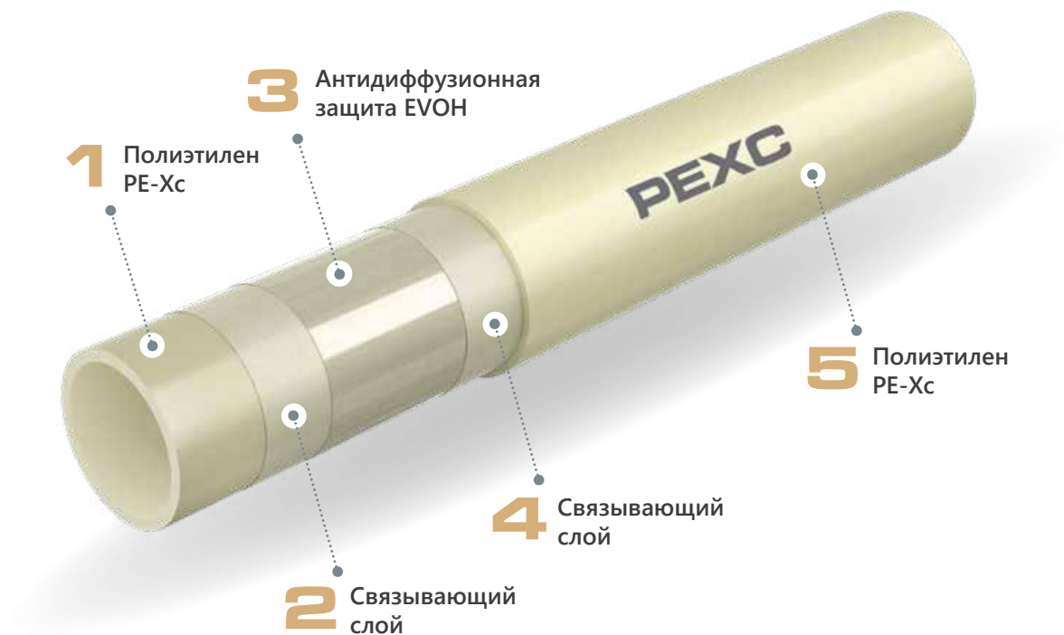
Конструкция трубы PEXC с антидиффузионным слоем
