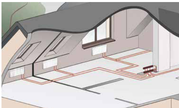
Распределительная разводка с тройниками в системе отопления.
