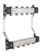
Распределитель группа применяется с конусными муфтами G¾" и муфтами G¾" для труб PERTAL. Выходы к отдельным контурам размещены с шагом 50 мм.
