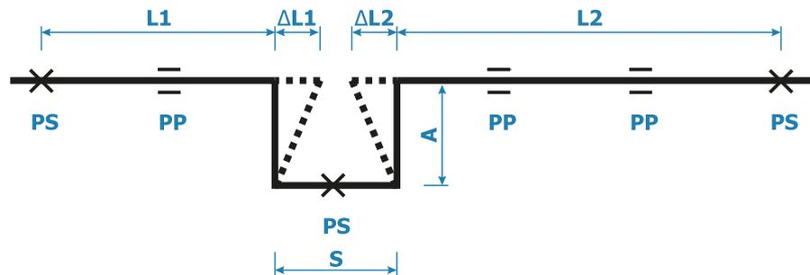
Компенсатор П-образный для стальных труб
