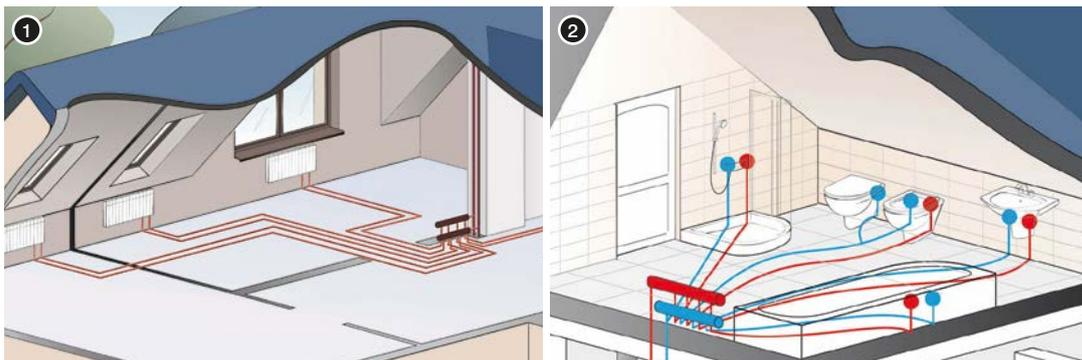
Потребители подключаются от стояка через сеть разветвленных трубопроводов, проложенных в полу и стенах и соединенных с помощью тройников. Диаметры труб уменьшаются постепенно по направлению к потребителям. Соединения труб размещаются в конструкции пола (можно под штукатуркой). По сравнению с лучевой разводкой уменьшается количество труб, используемых для подсоединения потребителей, но увеличиваются диаметры.
