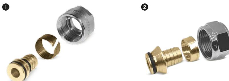
Соединение выполняется в той же последовательности, как описано выше. Следует помнить, что после накидывания на трубу обжимной гайки, нужно надеть разрезанное кольцо, а перед завинчиванием гайки передвинуть кольцо в направлении края трубы. Диапазон диаметров присоединяемых труб и размер гаек: Ø16 G $\frac{1}{2}$ ", Ø16 G $\frac{3}{4}$ ", Ø20 G $\frac{3}{4}$ " (для многослойных труб) и Ø16 G $\frac{3}{4}$ ", Ø20 G $\frac{3}{4}$ " (для труб PE-RT и PE-Xc).
