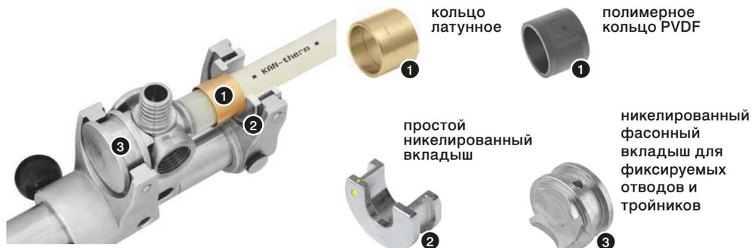
В случае необходимости демонтажа фрагмента оборудования (плохо выполненное соединение, модернизация) существует возможность повторно использовать демонтированный фитинг (только латунный). Фитинг необходимо вырезать вместе с фрагментами присоединенных труб, а затем нагреть соединение потоком горячего воздуха. После проверки технического состояния фитинга его можно заново использовать.
