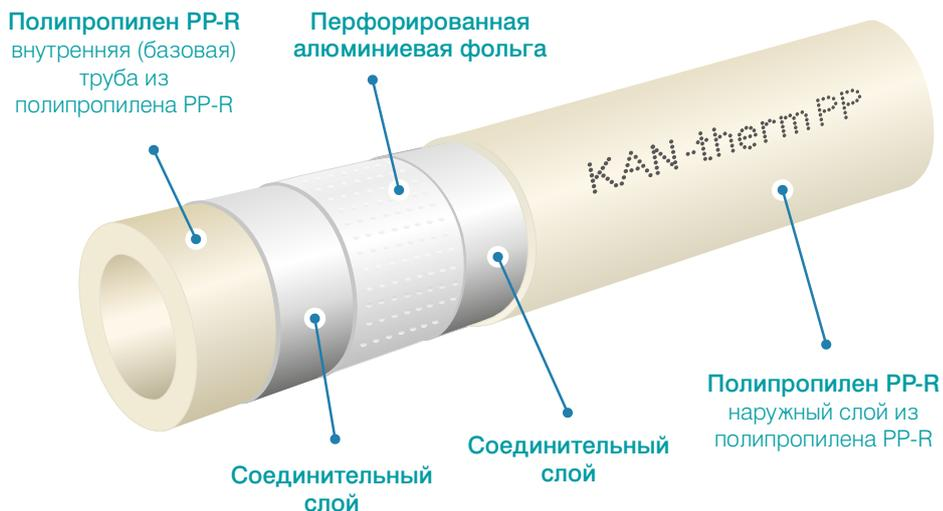
Конструкция комбинированной трубы KAN-therm PP Glass
