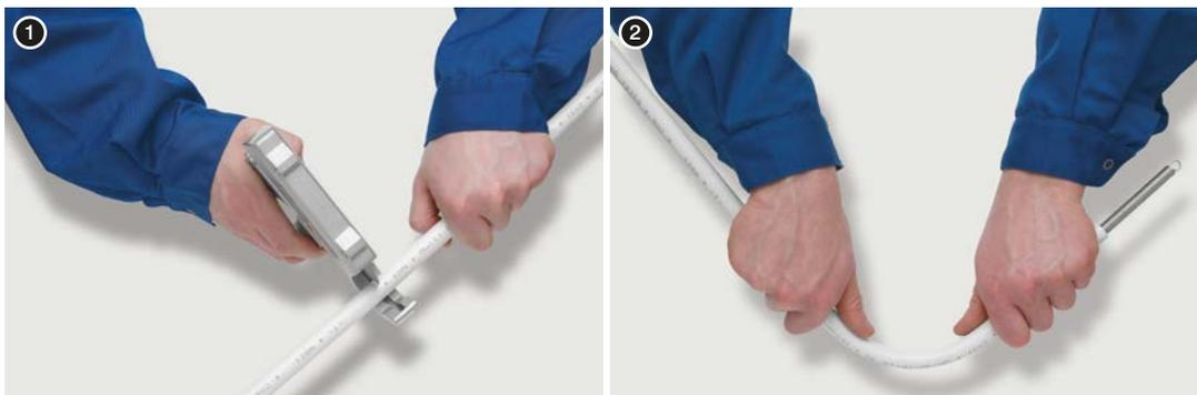
В случае соединителей KAN-therm Press LBP не требуется снимать фаску с внутреннего края трубы, при условии применения острого режущего инструмента и осевого монтажа трубы с фитингом! При больших диаметрах (25 и выше) для облегчения вставки штуцера соединителя в трубу рекомендуется воспользоваться калибратором.
