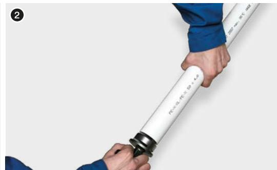
3. Правильно раскалиброванный конец трубы насадить на фитинг. Через контрольные отверстия в стальном кольце следует проконтролировать правильность вставки трубы - отверстия должны быть полностью закрыты трубой.
