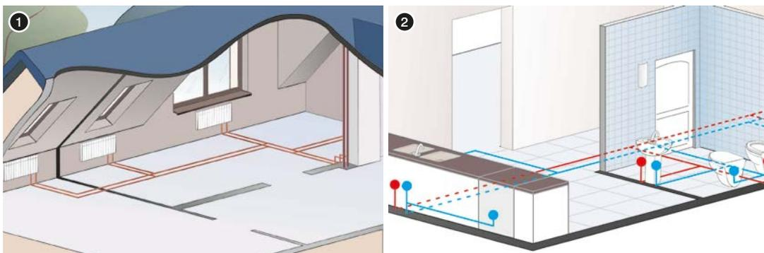
Применение: системы радиаторного отопления, системы холодного водоснабжения (ХВС) и горячего водоснабжения (ГВС), новые строительные объекты.
