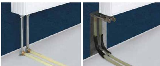
Для подключения отопительных приборов с нижним подключением Системы KAN-therm Push и Push Platinum предлагают оптимальные решения на базе специальных элементов (отводы и тройники) с медными трубками 15 мм или многослойными 16 мм (Узлы подключения отопительных приборов скрытая прокладка).
