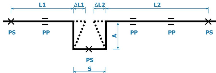
Компенсатор П-образный для стальных труб
