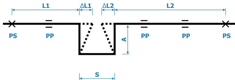
В этом случае длина плеча компенсатора  $A$  определяется из зависимости:
