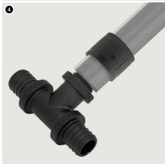
**⚠ В случае чрезмерного расширения трубы во время выполнения соединения может произойти "выдавливание" материала трубы между фитингом и кольцом. Чтобы предотвратить эту ситуацию, следует закончить процесс натяжения кольца на трубу перед опорным фланцем (следует удерживать зазор около 2 мм до фланца соединителя).**
