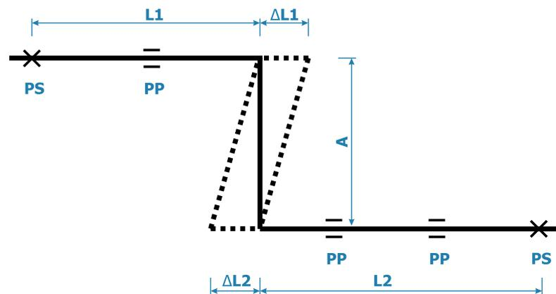
Для расчета длины компенсационного плеча  $A = L_s$  компенсатора необходимо принять за эквивалентную длину  $L_{\Sigma} = L_1 + L_2$ . Для этой длины определить удлинение  $\Delta L$  (из формулы или таблицы), а потом значение  $L_s$  (по формуле или таблице). Длина плеча **A** не может быть больше максимального расстояния между креплениями для данного диаметра трубопровода. На компенсационном плече запрещается расставлять крепящие хомуты.
