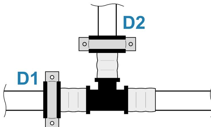
Пример выполнения точки неподвижной опоры на ответвлении трубопровода Системы KAN-therm PP: 1. труба; 2. муфта; 3. хомут; 4. тройник
