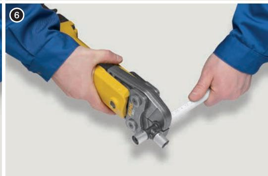
7. Разблокировать пресс-клещи и снять их с обжатого кольца. Соединение готово для испытаний давлением.
