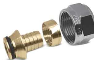
Соединение выполняется в той же последовательности, как описано выше. Следует помнить, что после накидывания на трубу обжимной гайки, нужно надеть разрезанное кольцо, а перед завинчиванием гайки передвинуть кольцо в направлении края трубы. Диапазон диаметров присоединяемых труб и размер гаек: Ø16 G $\frac{1}{2}$ ", Ø16 G $\frac{3}{4}$ ", Ø20 G $\frac{3}{4}$ " (для многослойных труб) и Ø16 G $\frac{3}{4}$ ", Ø20 G $\frac{3}{4}$ " (для труб PE-RT и PE-Xc).
