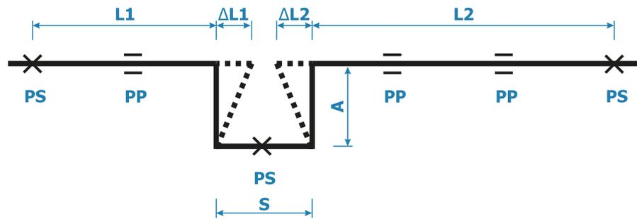
Компенсатор П-образный для стальных труб
