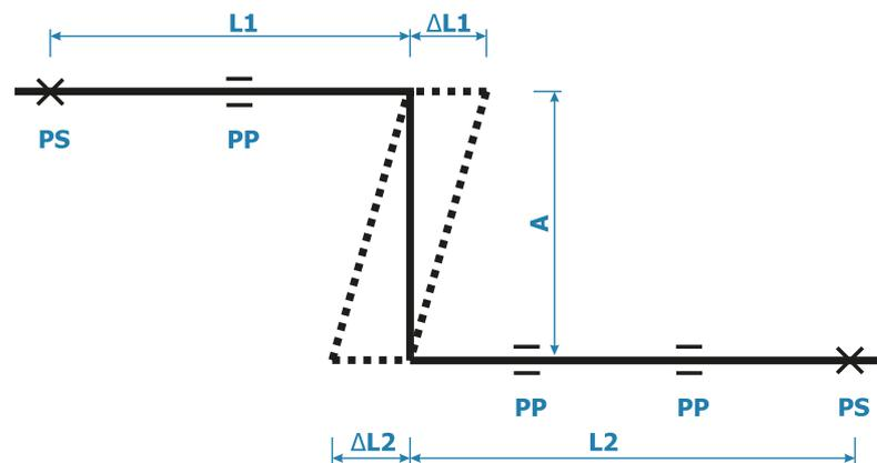
Для расчета длины компенсационного плеча  $A = L_s$  компенсатора необходимо принять за эквивалентную длину  $L_{\text{э}} = L_1 + L_2$ . Для этой длины определить удлинение  $\Delta L$  (из формулы или таблицы), а потом значение  $L_s$  (по формуле или таблице). Длина плеча **A** не может быть больше максимального расстояния между креплениями для данного диаметра трубопровода. На компенсационном плече запрещается расставлять крепящие хомуты.
