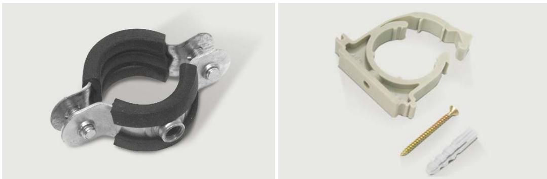
Хомуты могут изготавливаться из синтетического материала или металла. Пластмассовые кронштейны следует применять только в качестве подвижной (скользящей) опоры для трубопроводов Системы KAN-therm Push, Press и PP.
