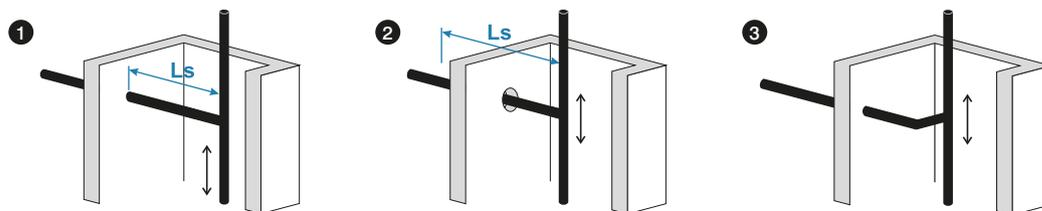
В случае труб Системы KAN-therm Push и PP можно отказаться от компенсации удлинения, располагая неподвижные опоры непосредственно при каждом тройнике отвления трубопровода. Это, так называемый, жесткий монтаж (Рис. с 96). С помощью деления стояка (неподвижными опорами) на относительно короткие участки (часто с длиной, равной высоте этажа, не больше 4 м), величина удлинений также будет небольшой, а возникшие напряжения будут компенсироваться посредством хомутов неподвижных опор.
