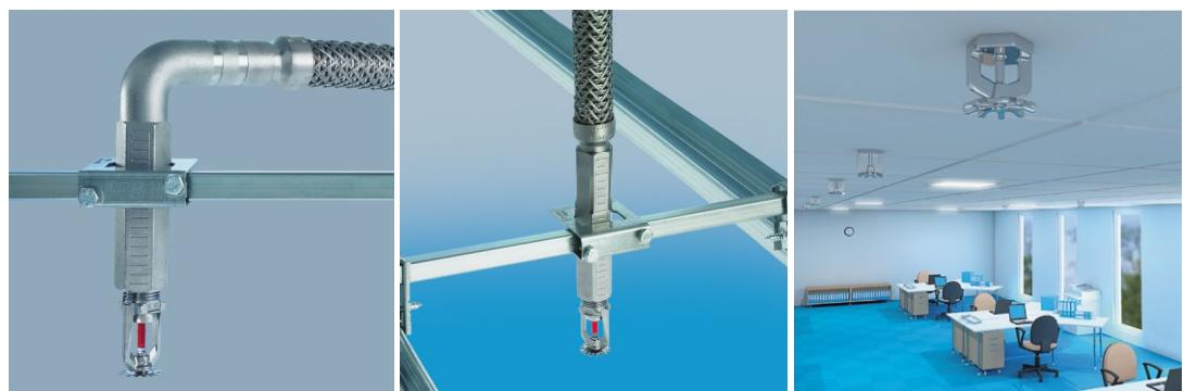
**Крестовины и соединители с накидной гайкой** делают возможным различные многообразные способы установки в зависимости от геометрии помещения. Фитинги с накидной гайкой не имеют ограничителя вставки трубы, поэтому отлично подходят для выравнивания уровня горизонтальной линии спринклеров (альтернатива для гибких соединительных шлангов).
