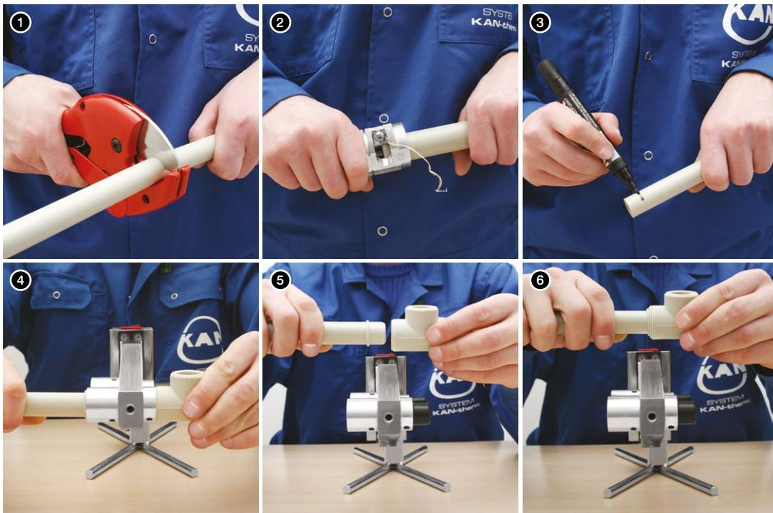
4. Нагрев трубы и соединителя.
